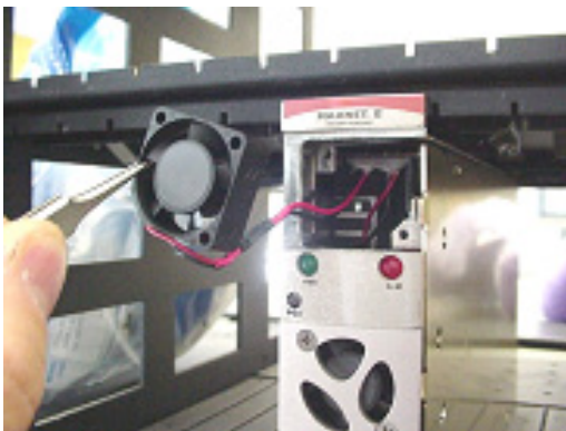
3. Pull out fan with tweezers.
