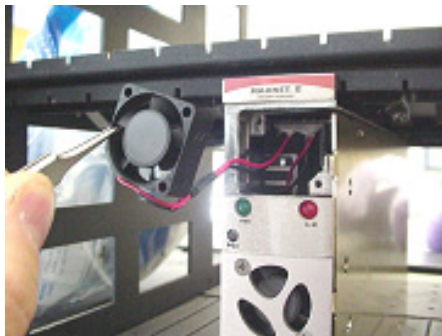
3. Pull out fan with tweezers.
